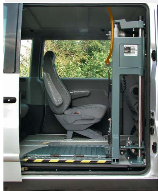
Possibilità di incassare la pedana nel pavimento.
